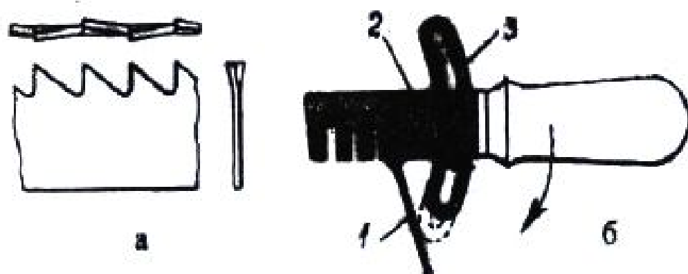
Расми 20. Танзими дандонаҳо: а-бо навбат қаттавии дандонаҳои арра ҳангоми тезкунии; б-танзимкунанда: 1-тасмаи арра, 2-танзимкунанда; 3-тақя.
