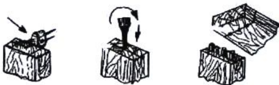
Расми 34. Пайдарпайӣ ва ҷобаҷокунии чузъиёт бо шкант: а-нишонагузории паҳлӯ; б-пармакунии сӯроҳӣ ба паҳлӯ; в-нишонагузорӣ, пармакунии сӯроҳӣ ва пайвасткунӣ.
